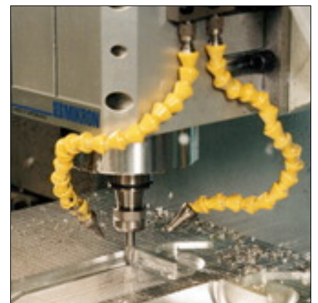
Hochgeschwindigkeitsfräsen von Kavitäten, Unilube-Minimalschmier-System mit 2 Düsen
